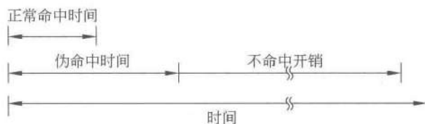
图 7.18 正常命中时间、伪命中时间和不命中开销之间的关系
